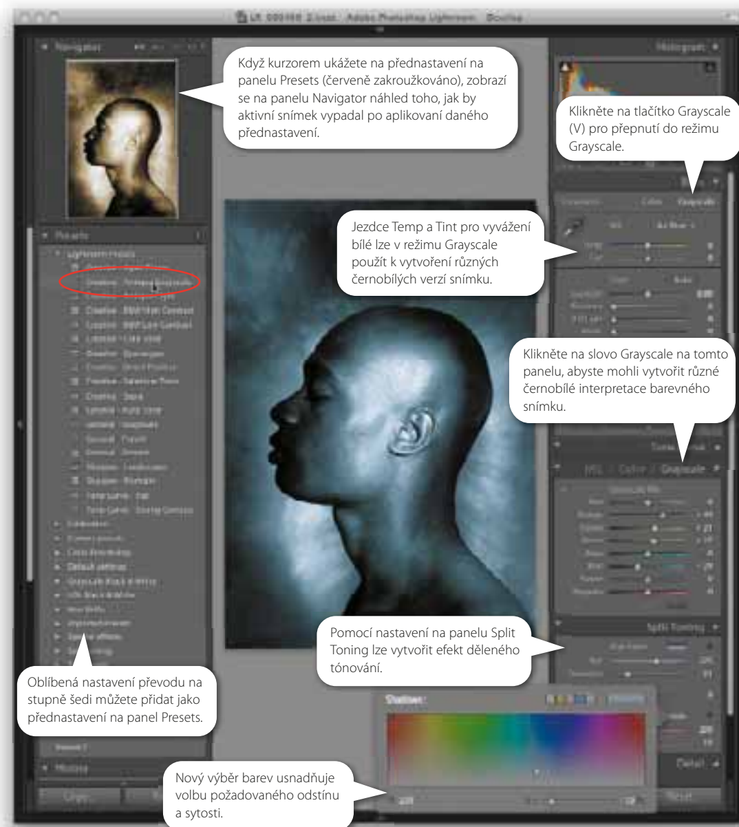
Obrázek 7.1 Na tomto snímku modulu Develop je popis hlavních nástrojů pro převod barevného obrazu na stupně šedi.
