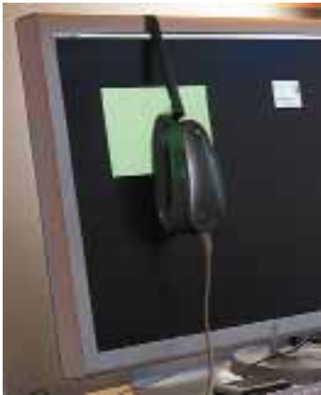
Obrázek 6.1 Já pro kalibraci monitoru v práci používám zařízení X-Rite Eye-One Photo
