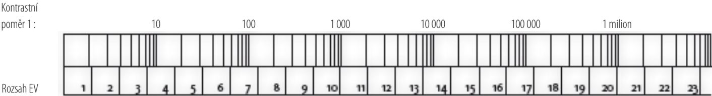
▲ Převodní stupnice: Dynamický rozsah měřený jako kontrastní poměr a rozsah EV.
