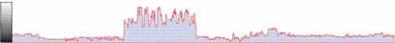
▲ Obraz jako signál. Pro zjednodušení jsem vybral jeden řádek pixelů a zakreslil světlost (jas) do grafu.
